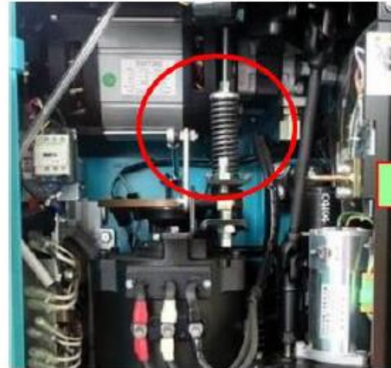
リーチ式フォークリフトのディスクブレーキ(デットマン式)
