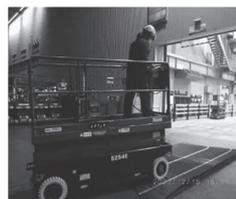
**傾斜規制点検台（高所作業車）**
