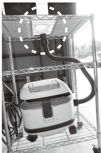
樹脂製漏斗を加工した吸塵口
