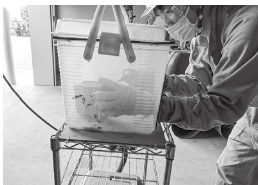
考案した装置でエアブロー作業実施中
