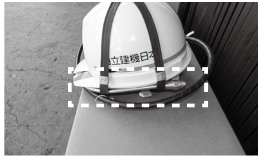
エアー用パイプの固定状況
