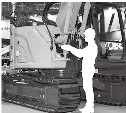
写真3 尿素水の給水
