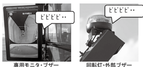
図7 物体検知、通知システムの構成
