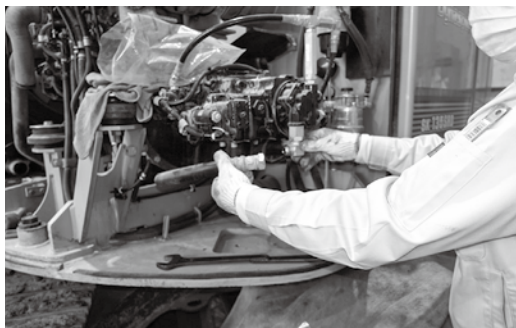
考案後の作業状況② ホース取外し→油漏れなし
