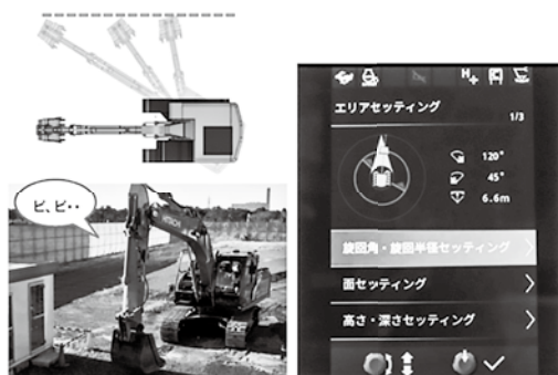
図10 エリアコントロールの使用例とモニタ表示例 (旋回領域設定の状況)
