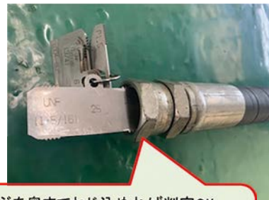
ゲージを奥までねじ込めれば判定OK 簡単にサイズ・種類が判別できる。 * 反対側にはねじ込めない
