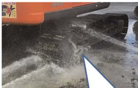
シューに汚れがこびりついて落ちにくい時は、前横方向からの噴射で落ち易くなる。 * 自動洗車機では不可能な角度で洗車可能。
