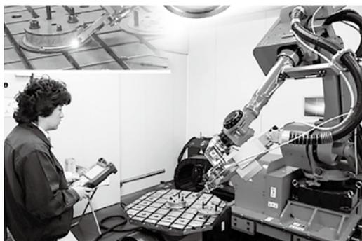
写真 9 レーザー加工機
