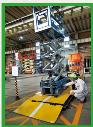
Q, S：高所作業車の傾斜機能確認試験 とメーカー別機種別基準値揭示
