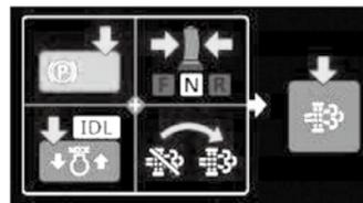
駐車ブレーキの解除をし忘れの際の操作手順(左)と排出ガス後処理装置の再生手順(右)
