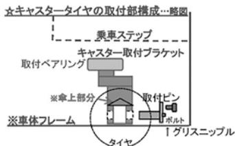
注…車種によって取付ブラケットの※傘状の部分とキャストータイヤ内幅で干渉するのでその場合は摩耗タイヤ取外し時と同じ幅にして新タイヤの片方を仮付しピン取付後にその片方を取付る。
