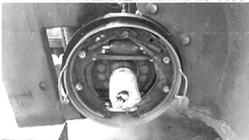
写真-2 ブレーキに治具装着
