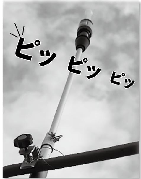
「はさまれん棒」をセットすることで挟まれ事故の危険を音と光でお知らせします。手摺の上下2箇所固定するので、設置箇所が自由に選べます。
