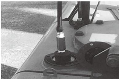
\* 作動油タンクの給油口にホースを差し込みポンピング
