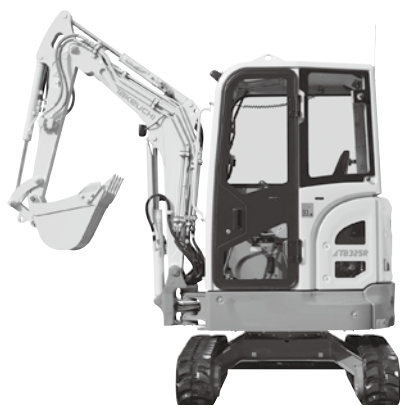
上部体を90度旋回させた状態 (運転席後方の“はみ出し”が少ない)
