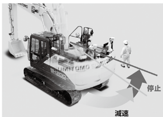
図3 走行・旋回時の減速・停止制御のイメージ
