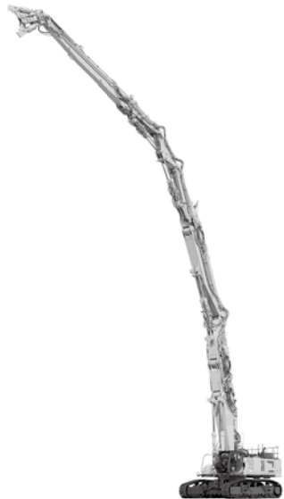
超大型建物解体専用機「SK1300 DLC」 （4 つ折れ超ロングアタッチメント仕様40mタイプ）
