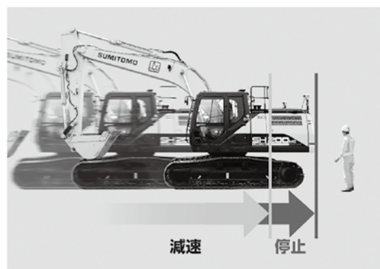
図3 走行・旋回時の減速・停止制御のイメージ
