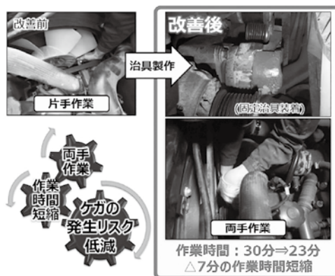
図 8. テンショナ固定治具の検証
