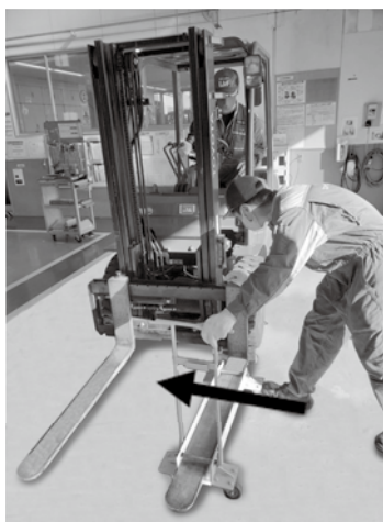
治具使用の作業状況 (治具スライド(フォーク挿入))
