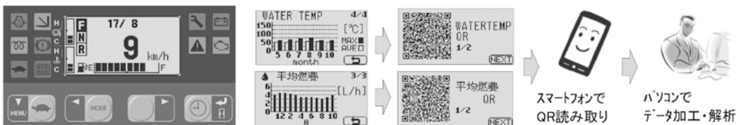
図5：稼働データログ機能の情報流れについて
