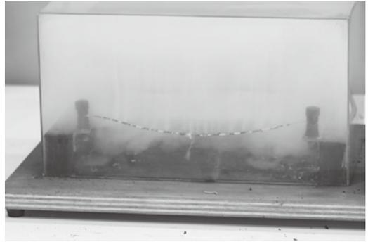
過電流による電線発火
