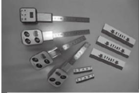
**シリンダー沈下量測定器**
