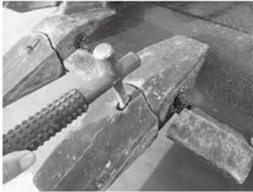
バケット爪交換時ロックピンを抜くとき専用のピン抜き治具を使用しているが、片手でピン抜き治具を持ち、片手でハンマーを使うことが通常の作業でした。
