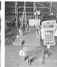
一体型「分割」検査ウエイトを製作した事により、1セットで試験荷重の異なる機種のクレーン荷重試験にも適合した検査ウエイトの準備対応が可能となった。
