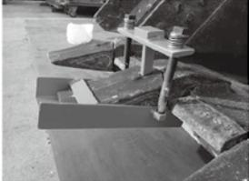
**バケツツース・ロックピン抜き安全治具**
