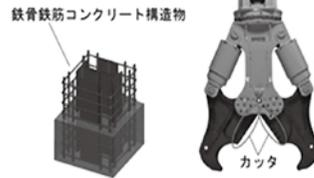
アーム先端でコンクリートを破砕し、カッタ・切断刃で鉄骨を切断
