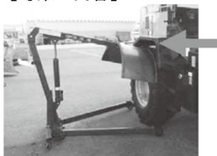
鋼板をタイヤ形状に曲げ、端部にフックを溶接した治具を作製、市販エンジンジャッキと組合せて使用する。
