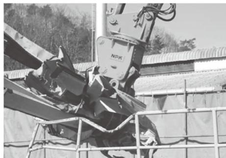
写真1 ソーティンググラブSG120/12tonクラス
