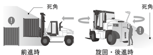
図2 中・大型フォークリフトの死角
