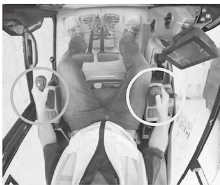
写真5 従来のブレード操作
