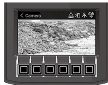
写真12 モニタ下部リアビューカメラ画面
