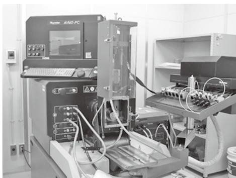
AVM2-PCの魅力は簡単な操作にあります。また、安全性も考慮され、フライホイールは完全にテストスタンドに内蔵され、電気部品は電気キャビネット内に収納されています。緊急停止スイッチは装置の両側から操作可能で、駆動は独立したスイッチで制御され、万一PCの誤操作があったとしても、予期せず装置が作動する事はありません。
