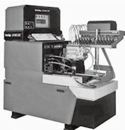
ハートリッジ社製計測システム「magmaH : Windows対応」を搭載し、試験結果は液晶画面で表示し保存する事も出来ます。試験項目は画面より種々選択が可能で、オプション装置を付加することによりコモンレールシステム上の計測も可能になります。
