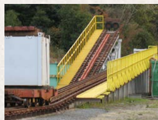
▲ 急勾配試験軌道
