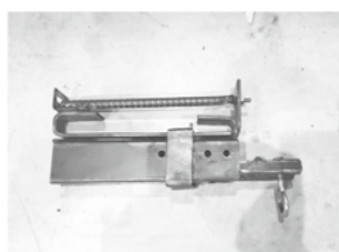
吊下げ用治具部分
