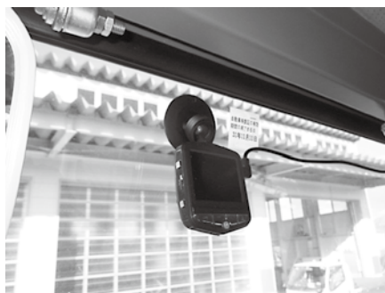
写真－2：整備回送中用の簡易『ドライブレコーダー』
