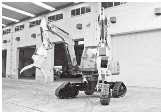
四脚クローラ方式を採用した双腕型コンセプトマシン
