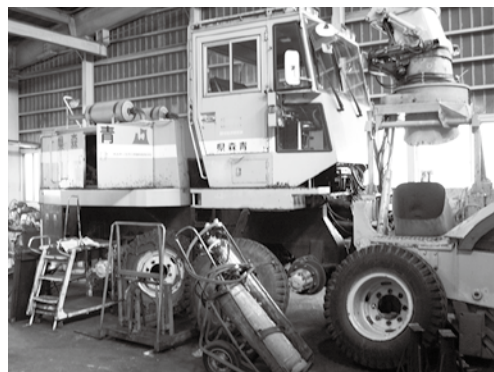
整備中のロータリー除雪車
