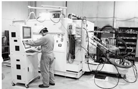
MH-R220は従来の油圧ドライブ型油圧機器試験機に比べ、インバータ制御電動モーター駆動、及びエネルギー一回生回路の採用により大幅な消費電力量の削減を実現しました。大型油圧ポンプの試験も可能です。
