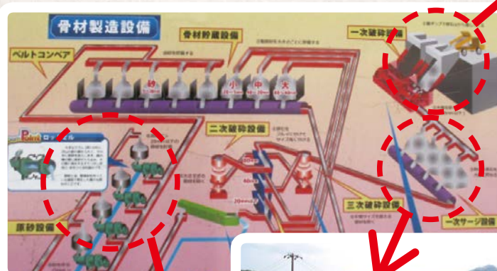
原石山から運び込まれた原石を一次破碎設備に投入
