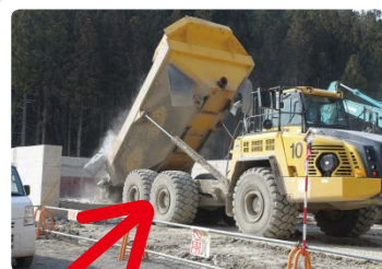
原石山から運び込まれた原石を一次破碎設備に投入
