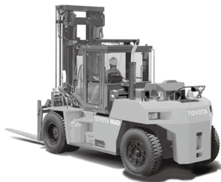
16トン積ディーゼルエンジンフォークリフト （オプション装着車）
