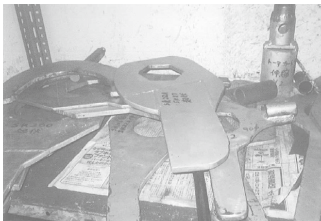
自作の治具-1 (シリンダーヘッド片ロメガネ)
