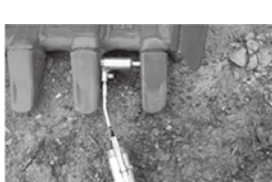
「グリスポンプでツースのピン抜き」「タイヤ「楽楽」脱着パネル」
