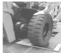
「グリスポンプでツースのピン抜き」「タイヤ「楽楽」脱着パネル」
