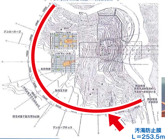
〔汚濁防止膜施工概要図〕
