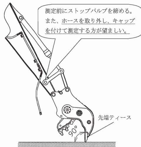
図 7-21 開閉シリンダー伸縮量の測定
