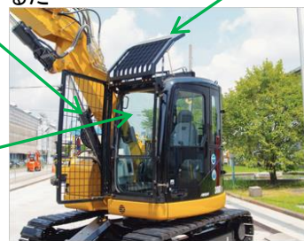
運転室周りの飛来物防護設備の例
