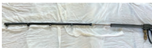
ラジエター洗浄治具全景
