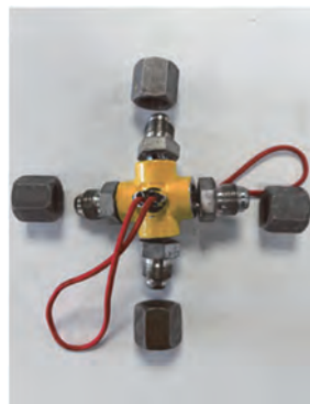
考案したプラグセット (1セットで4本の油圧ホースに対応)
