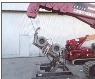
作業状況 (本体重量でワイヤーにテンションを掛けます)
