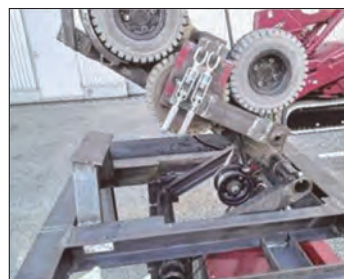
駆動部と土台の連結状況 本体が吊り上げられる構造
