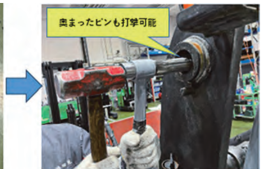
使用状況②（突き出し量調整可能）
