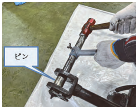
使用状況①（打撃でピンを抜く）
