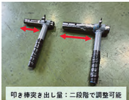
使用状況②（突き出し量調整可能）
