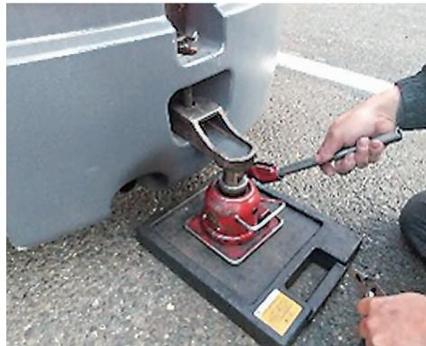
ウエイト後部のドローバーピンを使用してジャッキアップ
