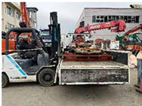
『大割機』を安全に固定してフォークリフトで運搬したり、積み込みしたり出来ます
