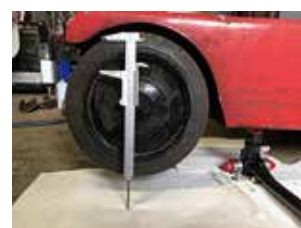
左ロードタイヤリフトアップ写真ノキス50mm程度up
