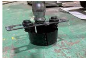
スライディングハンマーを取付けられるように加工し、治具取付部は長穴にして色々なクラスの転輪に対応できるようにしました
