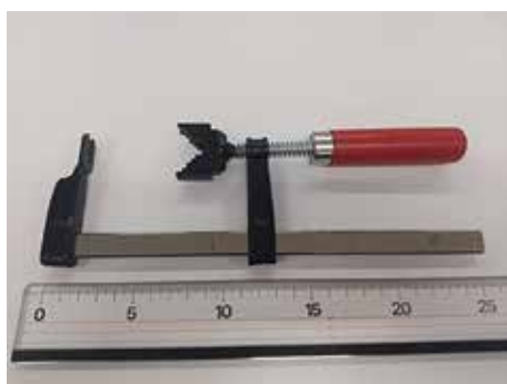
考案した治具全景 (市販のバイスプライヤーを改良)
