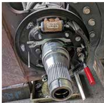
ライニング後部にバイスプライヤー を固定、調整部を回す
