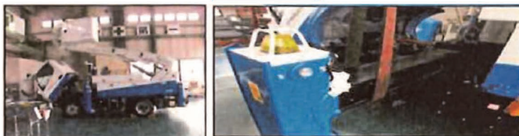
車輛をセットし、天井クレーンでアウトリガを脱着
