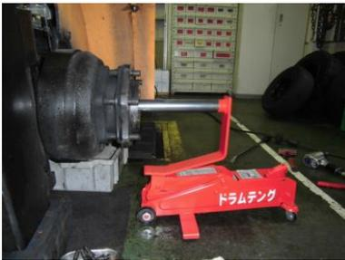
① ジャッキで高さ調整しホーシングに直接パイプシャフトを差し込む。
