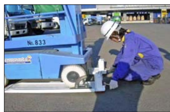
微調整は角度計にて測定を実施する
