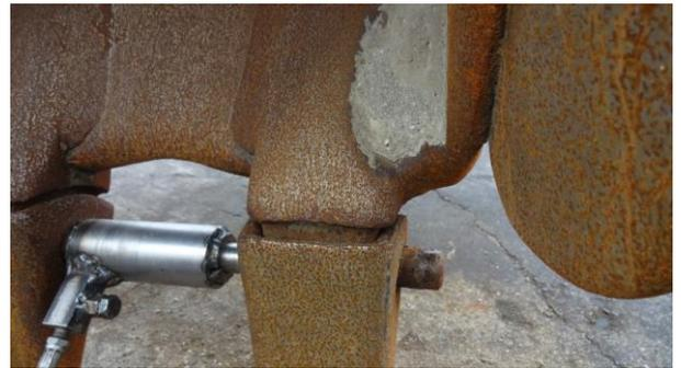
・高圧グリスポンプ(CH-650)の能力50Mpa越えるため、チャックタイプノズルでは状況により漏れる、1/8PTオス/オスニップル付の延長パイプにて直接ポンプアップ
