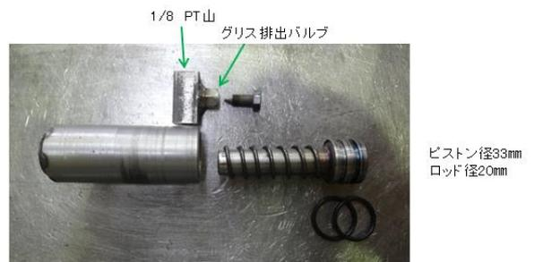
全長約120mm チューブ外径45mm
