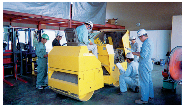
締固め用機械検査実技研修
