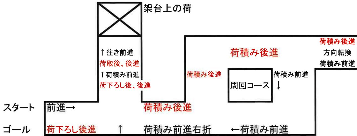
スタート地点から前進し、架台の前に進み、荷を積んだ後は後進で周回コースを半周します。方向転換所で向きを前向きに変え、前進で架台の前まで進みます。その後、後進でスタート地点に戻ります。
