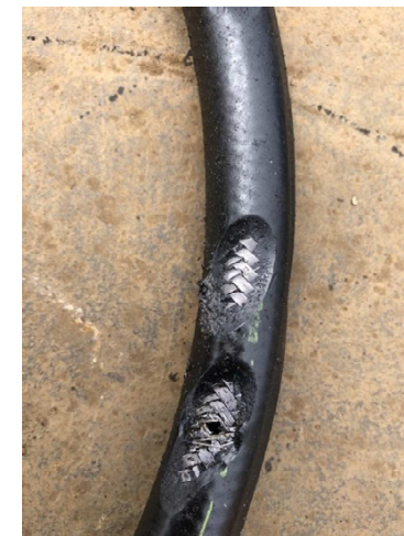
摩耗して穴の開いたステアリング配管ホース
