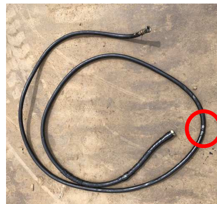
摩耗して穴の開いたステアリング配管ホース
