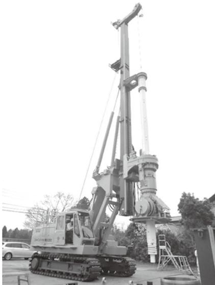
写真1 DHJ60-3多目的掘削仕様機
