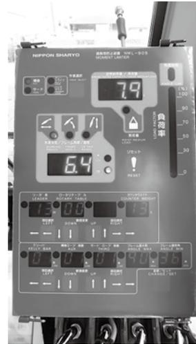
写真8 過負荷防止装置(モーメントリミッタ)
