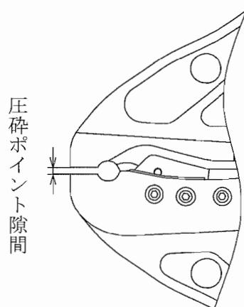
図 7-8 圧砕ポイント隙間測定
