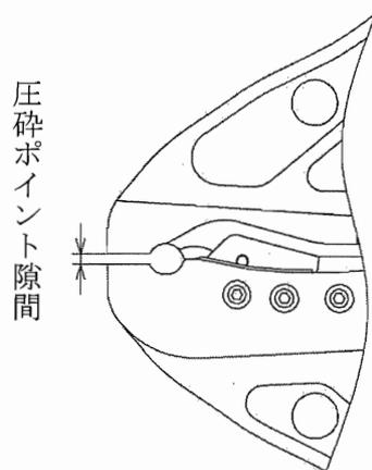
図 5-8 圧砕ポイント隙間測定
