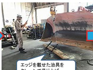
エッジを載せた治具をクレーンで吊り上げ。
