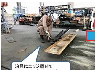
治具にエッジ載せてアジャストボルトで固定。
