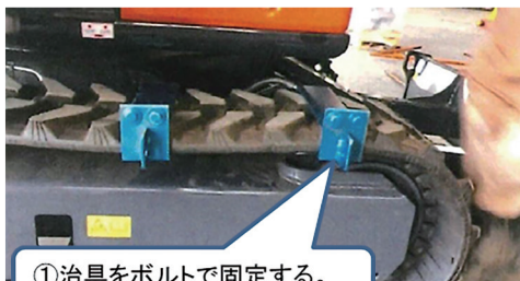
①治具をボルトで固定する。
