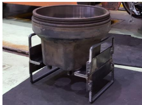
ターンバックルを緩めて治具から取り外す
