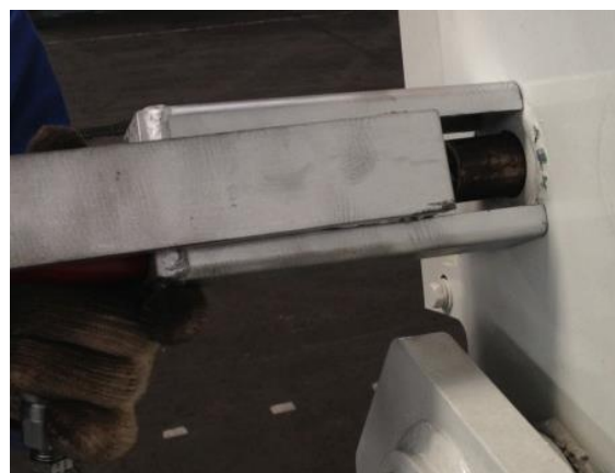
ポートパワーを作動させると徐々にシリンダーピンが抜けてくる。
