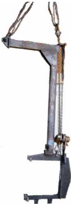
大型フォークリフト用フロントハブ脱着吊り具
