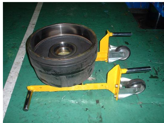
ドラム、ベアリング点検作業
