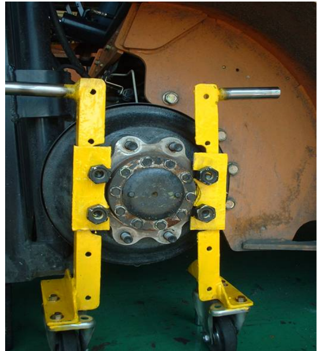
ドラムに治具を取り付けた状態
